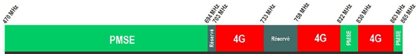
Avec le standard vidéo SECAM L, il existe une zone de fréquences récupérable dans la zone de rejet de fréquences. La zone complète s'étend de 694 MHz à 863 MHz. Cependant une zone de 8 MHz est récupérable à partir de 822 MHz. Cette zone s'appelle le « Duplex Gap ». Cette option est accessible lors de l'activation de cette zone de rejet :
